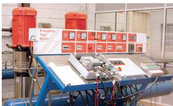
Banc d'essai hydraulique équipé de 7 pompes
